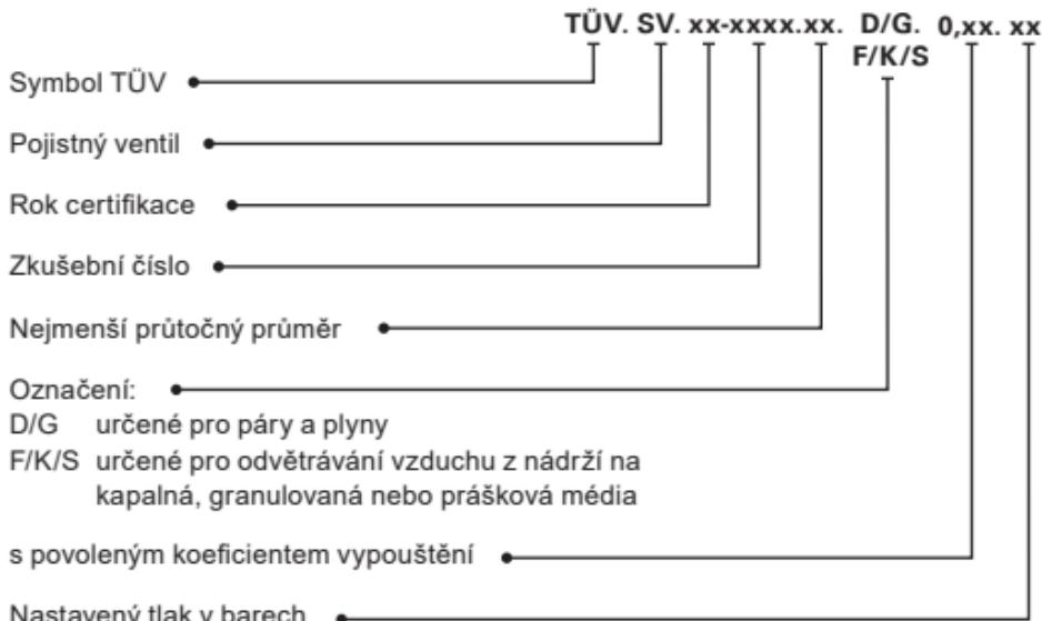
Pojistné ventily jsou zkoušeny na pevnost a těsnost a seřízeny a zaplombovány na požadovaný nastavený tlak.
