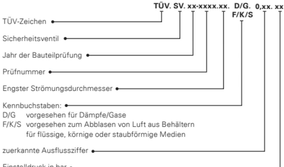
Sicherheitsventile werden von uns auf Druckfestigkeit und Dichtheit geprüft, auf den gewünschte Einstelldruck einjustiert und plombiert.
