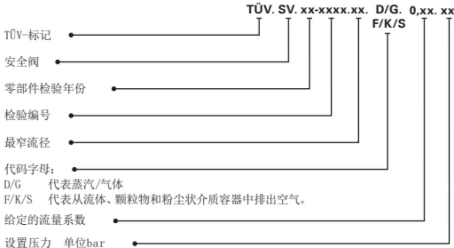
出厂前，所有安全阀通过了抗压强度试验和密封性试验，按客户需求调试好了设置压力并予以铅封。
