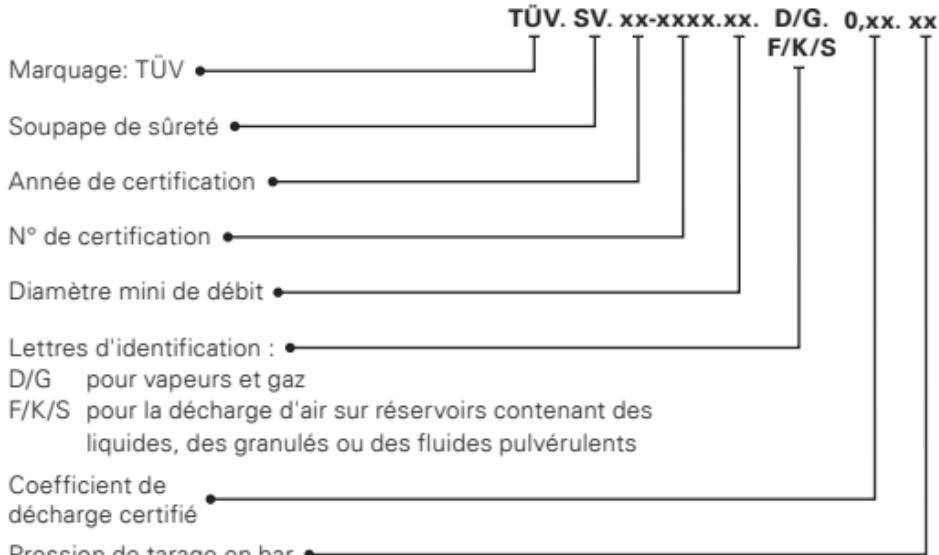
Nos soupapes de sécurité sont contrôlées quant à leur résistance à la pression et à leur étanchéité; elles sont réglées à la pression de tarage souhaitée et dotées d'un plombage.
